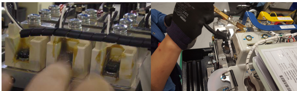
图 107 - SCR 螺丝绝缘润滑脂涂抹
