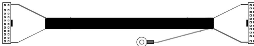
Figura 4-191 Arnés de cables del inversor
